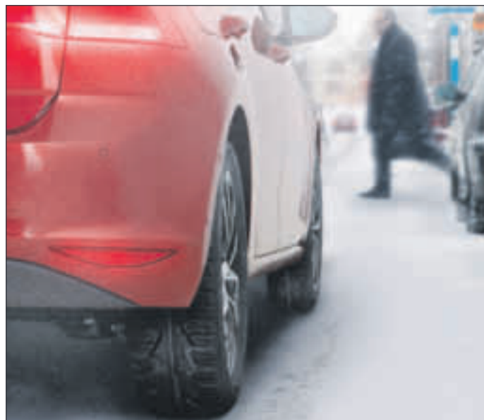
Mit innovativen Technologien (Profildesign, Gummimischung) garantieren moderne Winterreifen gute Traktion, hohe Aquaplaningsicherheit und kurze Bremswege. Foto: Uniroyal/interPress
